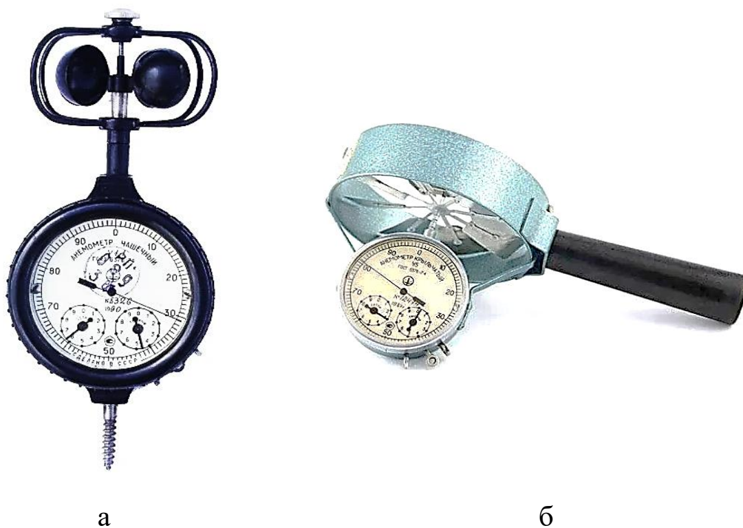
Рис. 12. Анемометры: а – чашечный; в – крыльчатый
