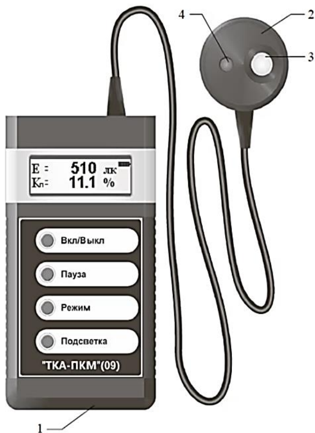
Рис. 18. Цифровой люксметр-пульсметр-яркомер ТКА-ПКМ 09: 1. Блок обработки информации. 2. Измерительная головка. 3. Фотоприемное устройство «Люксметр». 4. Фотоприемное устройство «Яркомер».
