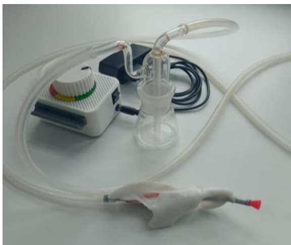
Рисунок 1. Внешний вид устройства для вакуумной фиксации ОЩЖ в сборе
