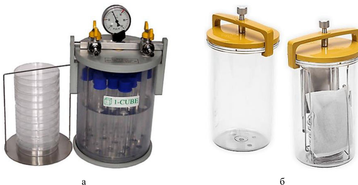
Рис. 63. Оборудование для культивирования анаэробных бактерий: анаэроостат 1-CUBE (а); анаэроостат GasPak 100 (б) ( https://kolba24.ru )
