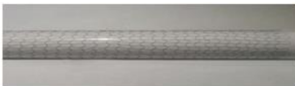
Рисунок 1 – Устройство из никелида титана марки ТН-10 машинного плетения с толщиной нити 40 мкм и внутренним диаметром 1,0 см
