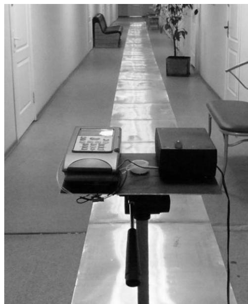
Рис. 1. Комплекс диагностики параметров ходьбы с использованием лазерного дальномера
