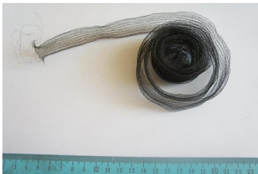
Рис. 10. Трубчатый имплантат из никелида титана
