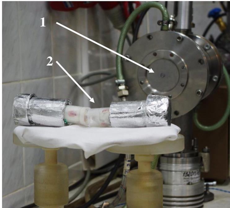
Рисунок 3. Источник наносекундного импульсно-периодического рентгеновского излучения Синус-150 (1) и мыши (2), помещенные в свинцовый экран на время облучения для обеспечения локального воздействия на мозг
