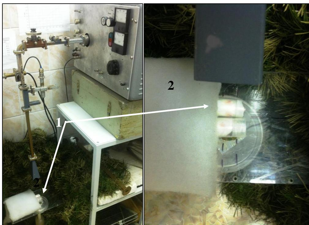
Рисунок 1. Стенд облучения головного мозга мышей ИПМИ. 1 – мыши, помещенные в контейнеры; 2 – радиопоглощающий материал, экранирующий тело животного от воздействия ИПМИ
