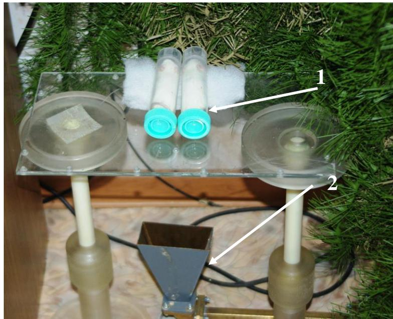
Рисунок 2. Воздействие ИПМИ на область расположения эпидидимальной жировой ткани у мышей. 1 – область расположения эпидидимальной жировой ткани, 2 – открытый конец рупора волновода
