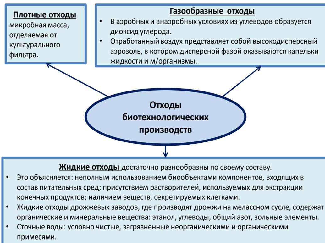
Рис. 17. Сортировка и утилизация отходов биотехнологического производства
