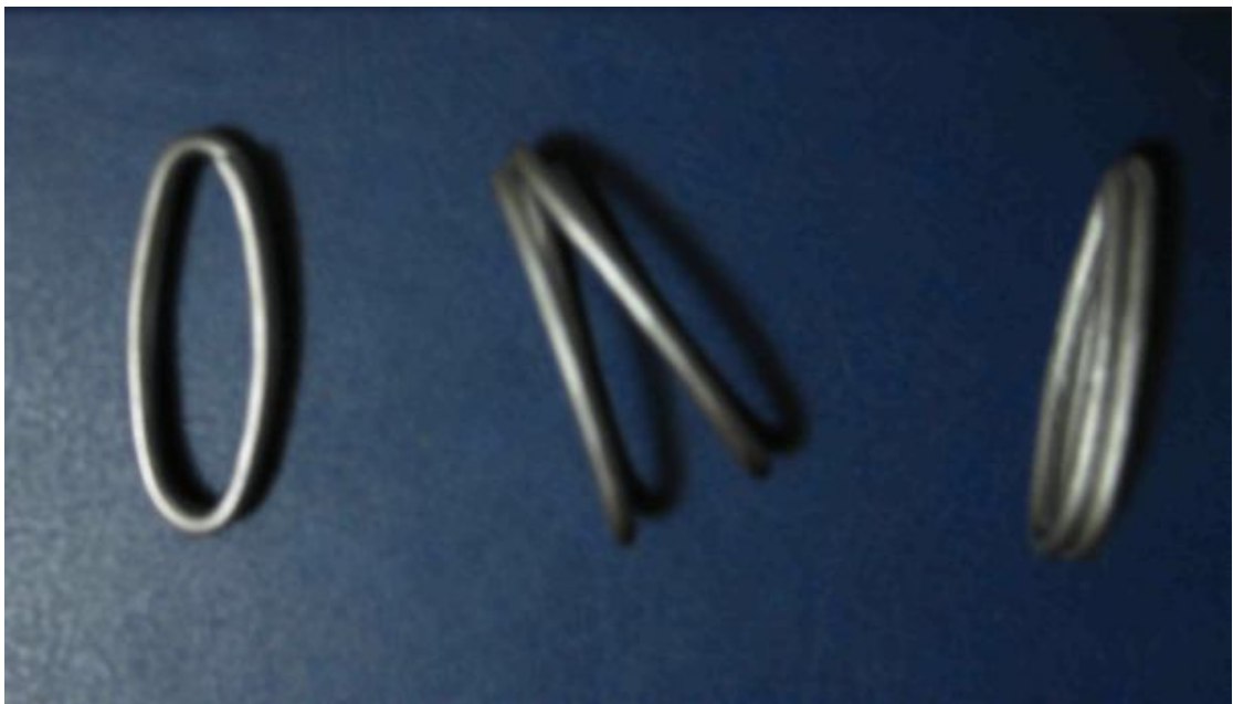
Рисунок 2 – Компрессионный элемент с памятью формы в исходном состоянии, после деформации и после восстановления формы
