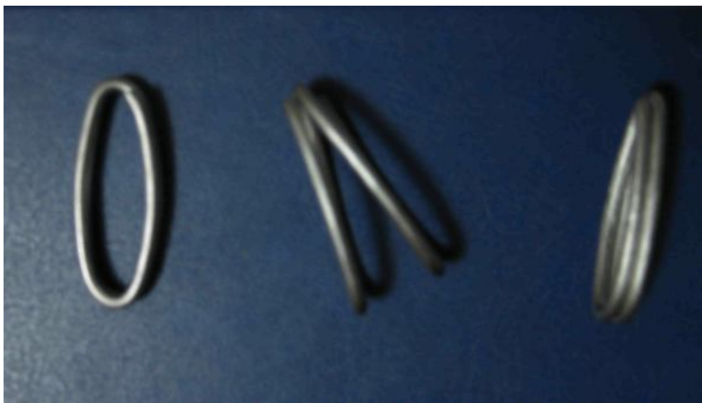
Рисунок 1 – Компрессионный элемент с памятью формы в исходном состоянии, после деформации и после восстановления формы
