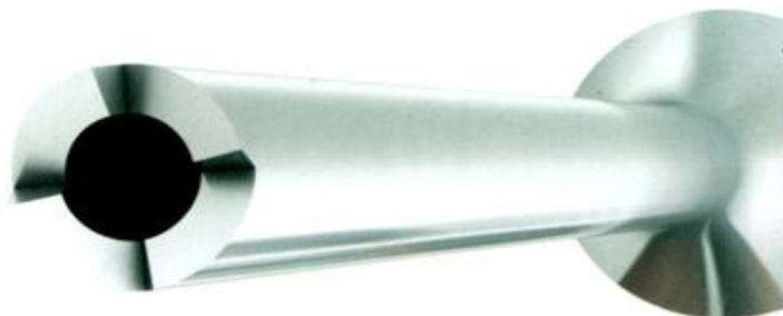
Рис. 80. Бор-трепан имеет такой же внешний диаметр, что и Gates Glidden №3 и центровочный дрель (0,9 мм). Внутренний просвет трепана имеет диаметр 0,5 мм и длину 5 мм. Им работают против часовой стрелки
