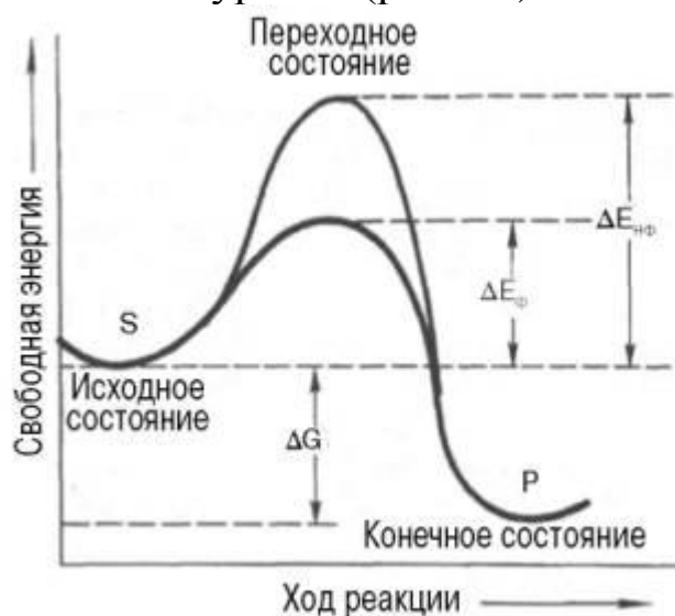
Рис. 30. Энергетический механизм ферментативной и неферментативной химических реакций: S – исходный субстрат; P – продукт; \Delta E_{нф} – энергия активации неферментативной реакции; \Delta E_{ф} – энергия активации ферментативной реакции; \Delta G – стандартное изменение свободной энергии
