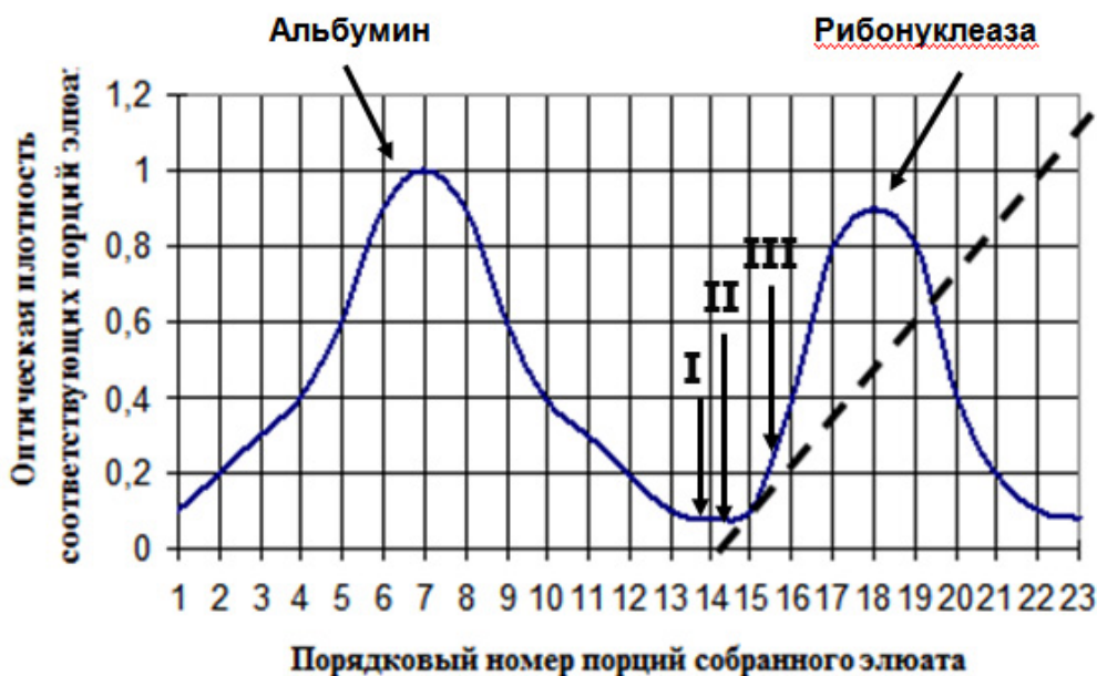
Рис. 3. График распределения альбумина и рибонуклеазы в порциях собранного элюата
