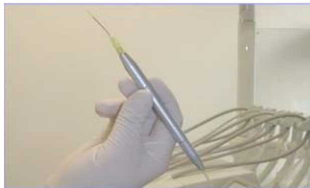
Рис. 2.23. Современный лазерный световод для медицинских приложений
