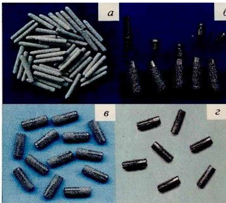
Рис. 38. Дентальные комбинированные имплантаты из никелида титана: а – цельнопористые имплантаты с внутренней монолитной основой, б – имплантаты с наружным пористым покрытием, в – имплантаты с внутренней пористой структурой, г – имплантаты резьбовые с комбинированной наружной и внутренней пористой структурой
