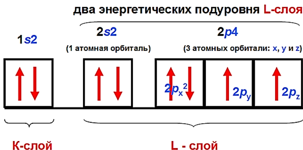
Рис. 3. Схема строения энергетических подуровней атома кислорода
