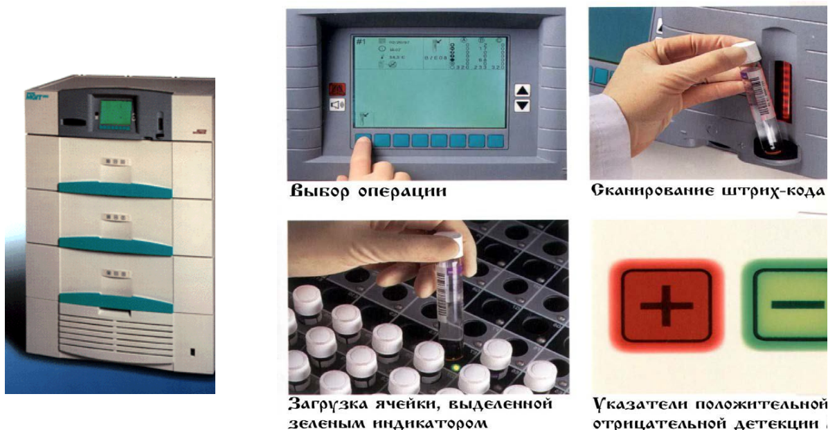
Рис. 3. Автоматизированная система культивирования микобактерий: MGIT-BACTEC-960 и основные этапы исследования
