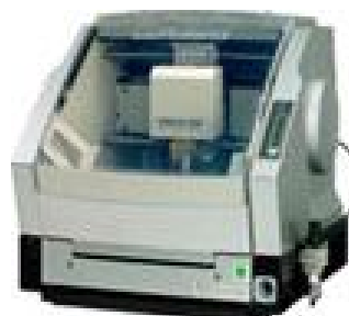
6. Вытачивание протезов на станке с ЧПУ
