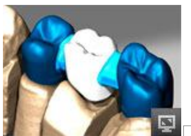
Соединительные звенья создаются автоматически, но являются редактируемыми элементами
