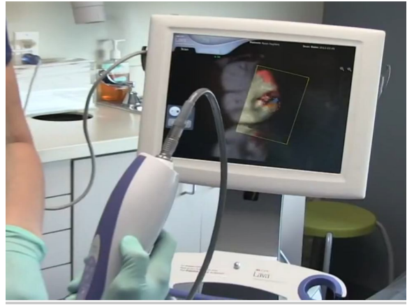
Рис. 51. Вывод 3D-изображения полости рта на экран монитора
