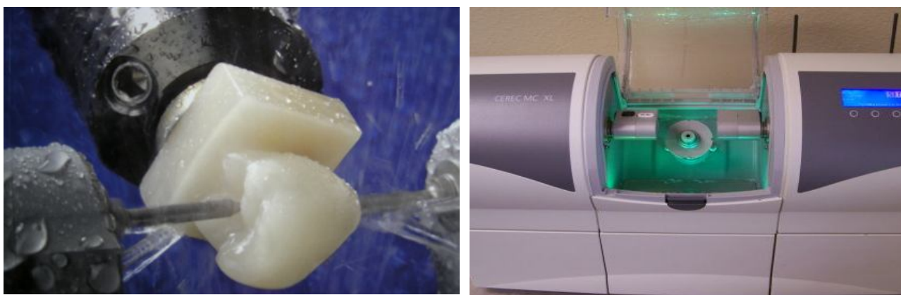
Рис. 48. Обработка керамической заготовки
