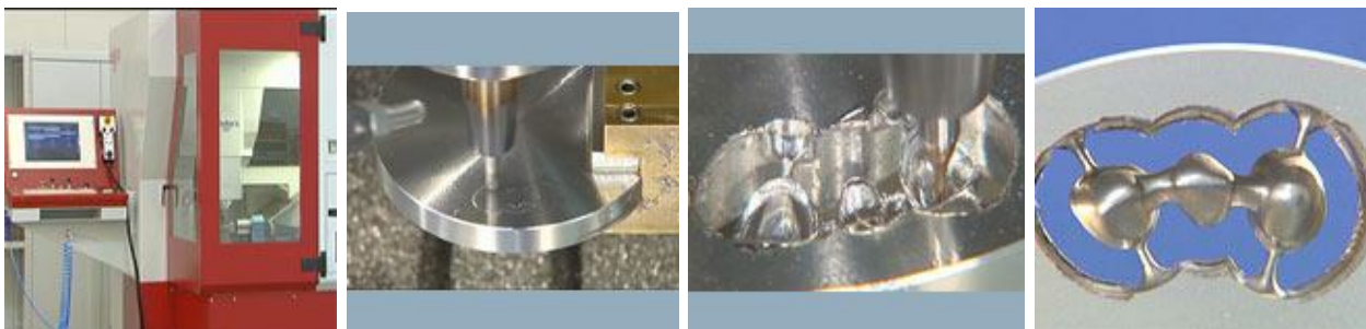
Рис. 45. Изготовление протеза из титана. Фрезерный станок Rodes
