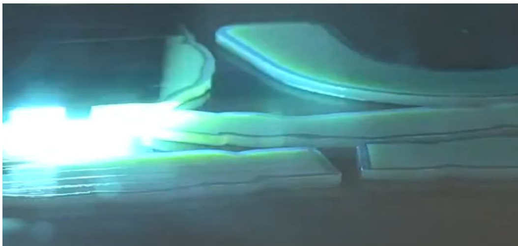
Рис. 54. Процесс послойной печати зубных протезов на 3D-принтере
